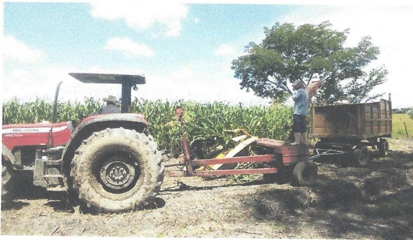
Como se muestra en la imagen el proceso del ensilaje es cortar la milpa verde con una maquinaria llamada la trilladora lo cual pasa y muele la planta, es donde pasa al contenedor para su almacenaje, después de esto es llevado a un lugar para su comprimirlo.
